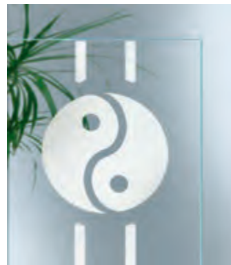
Bsp. Grundglas Float 4 mm klar Ausführung Motiv matt/Glas klar, gefertigt ab Werk ohne Oberflächenschutz, jedoch als Zusatzleistung bestellbar. Durch den Auftrag erhält die weiße sandgestrahlte Fläche ein dunkleres seidenmattes Aussehen, ähnlich dem Glas Satinato.
